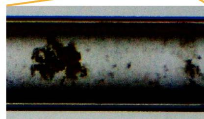
地上で酵素合成されたセルロースは、沈殿が生じ不均一です。
